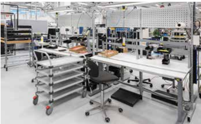
Herkkien sähkökomponenttien käsittelyyn valittiin ESD-kalusteet.
